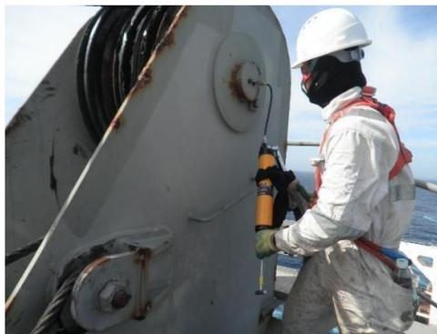
Gambar 3. Awak kapal melakukan pelumasan gear crane
