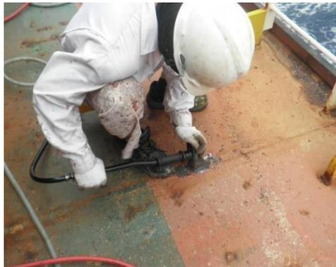
Gambar 1. Awak kapal melakukan perawatan yaitu chipping menggunakan mesin ketok
