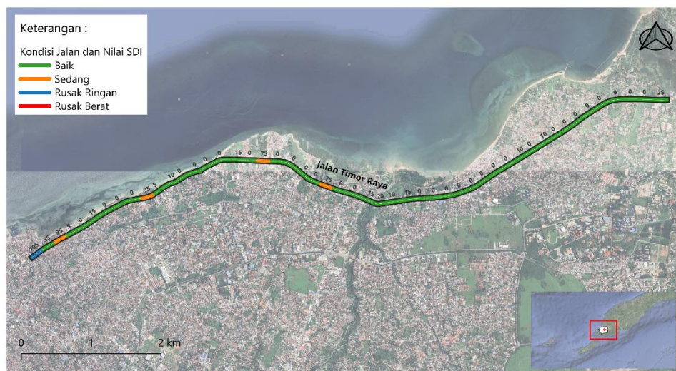
Gambar 3. Peta Kondisi Perkerasan Jalan Timor Raya Berdasarkan Metode Surface Distress Index (SDI)
