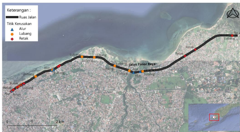
PETA TITIK KERUSAKAN Ruas Jalan Timor Raya, Kota Kupang, NTT
