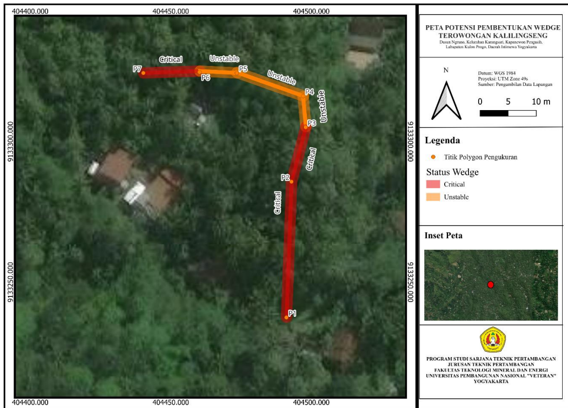
Gambar 4. Peta Spasial Potensi Pembentukan Wedge Terowongan Kalilingseng
