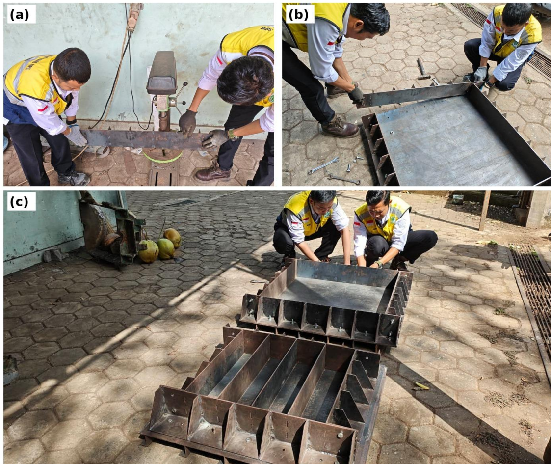
Gambar 3. Tahapan fabrikasi dan perakitan prototipe: pembuatan lubang sambungan, pemasangan panel pada base plate, serta konfigurasi balok dan pelat
