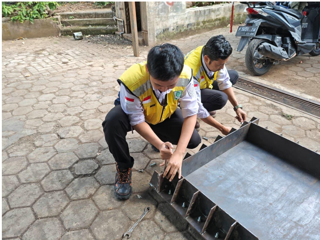
Gambar 3. Tahapan fabrikasi dan perakitan prototipe: pembuatan lubang sambungan, pemasangan panel pada base plate, serta konfigurasi balok dan pelat
